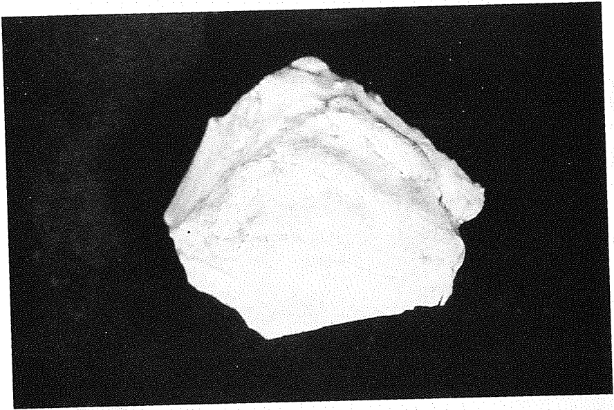
DOGHOUSE'DAN ALINMIŞ ÜZERİNDE HARÇ BULUNAN AZS BLOK KESİTİ
